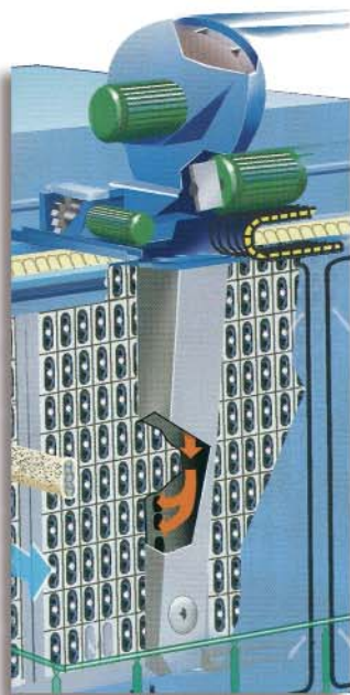
▲ Contre courant à faible pression à chariot (off line)
